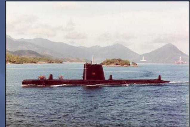
US-Balao-Klasse, Verdrängung: 1526/2424 t, Länge: 95,02 m, Breite: 8,31 m, Tiefgang: 5,13 m, Geschwindigkeit: 20,25/8,75 kn, 4 Diesel- und 4 E-Motoren, Besatzung: 81, Bewaffnung: 10 Torpedorohre, 3 Bordkanonen; Kiellegung: 29.06.1944, Stapellauf: 21.12.1945, Indienststellung: 07.06.1946, an Brasilien: 19.12.1973, Außerdienststellung: 15.10.1992; Bauwerft: Electric Boat Company, Groton, Connecticut, USA. – Lp-Brief aus Rio de Janeiro vom 10.06.1976 mit Bordstempel des U-Bootes (Foto: wikipedia)
