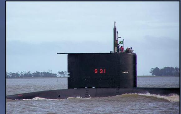
Typ deutsch 209/1400/Tupi-Klasse, Verdrängung: 1150/1440 t, Länge: 21,6 m, Breite: 6,2 m, Tiefgang: 5,5 m, Geschwindigkeit: 11/21,5 kn, diesel-elektrischer Antrieb, Besatzung: 36, Bewaffnung: 8 Torpedorohre; Kiellegung: 15.07.1986, Stapellauf: 18.11.1993, Indienststellung: 17.07.1995; Bauwerft: Arsenal de Marinha do Rio de Janeiro, Brasilien. – Brief aus Marcilio Dias vom 12.03.2002 mit Dienststempel des Kommandanten (Foto: wikipedia)
