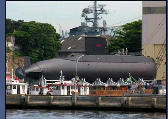
Typ deutsch 209/1400/Tupi-Klasse, Verdrängung: 1150/1440 t, Länge: 21,6 m, Breite: 6,2 m, Tiefgang: 5,5 m, Geschwindigkeit: 11/21,5 kn, diesel-elektrischer Antrieb, Besatzung: 36, Bewaffnung: 8 Torpedorohre; Kiellegung: 15.09.1987, Stapellauf: 05.01.1996, Indienststellung: 16.12.1996; Bauwerft: Arsenal de Marinha do Rio de Janeiro, Brasilien (Foto: U-Boot auf Stapel). -Brief aus Rio de Janeiro vom 24.04.2003 mit Dienststempel des Kommandanten (Foto: wikipedia)
