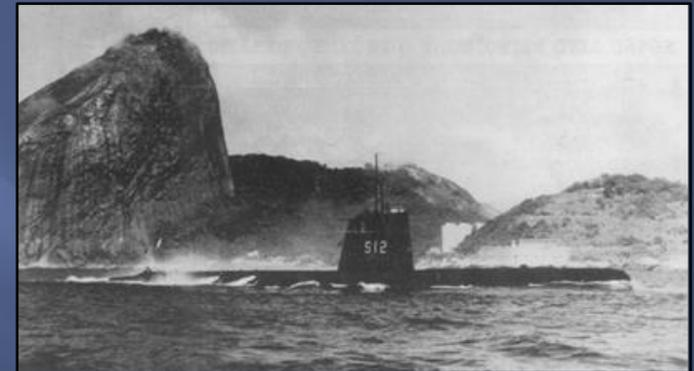
US-Tench-Guppy II-Klasse, Verdrängung: 1870/2420 t, Länge: 93,7 m, Breite: 8,3 m, Tiefgang: 5,5 m, Geschwindigkeit: 18/15 kn, 4 Diesel- und 4 E-Motoren, Besatzung: 83, Bewaffnung: 10 Torpedorohre; Kiellegung: 07.11.1944, Stapellauf: 02.03.1945, Indienststellung: 11.06.1945, an Brasilien: 27.03.1973, Außerdienststellung: 14.07.1993; Bauwerft: Portsmouth Naval Shipyard, Kittery, Maine, USA . - Dienstbrief aus Marcilio Dias vom 09.01.1980 mit Bordstempel des U-Bootes(Foto: wikipedia)
