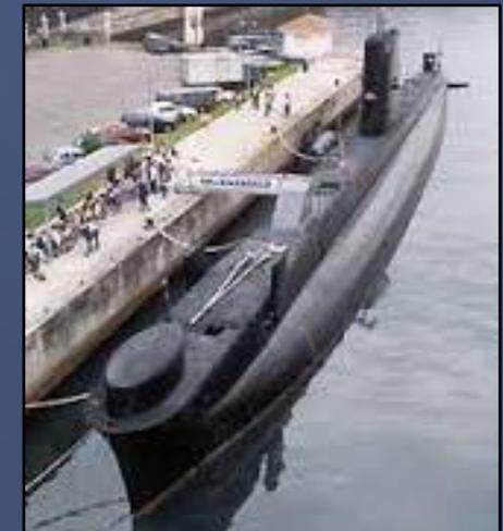
Britisch-Oberon-Klasse, Verdrängung: 1620/2040 t, Länge: 89,9 m, Breite: 8,07 m, Tiefgang: 5,48 m, Geschwindigkeit: 17,5/15 kn, 2 Diesel- und 2 E-Motoren, Besatzung: 74, Bewaffnung: 8 Torpedorohre; Kiellegung: 26.05.1973, Stapellauf: 06.09.1975, Indienststellung: 12.03.1977, Außerdienststellung: 12.11.1997; Bauwerft: Vickers Limited, Barrow-in-Furness, UK. -Dienstbrief aus Rio de Janeiro vom 27.06.1978 mit Dienststempel des Kommandanten (Foto: wikipedia)
