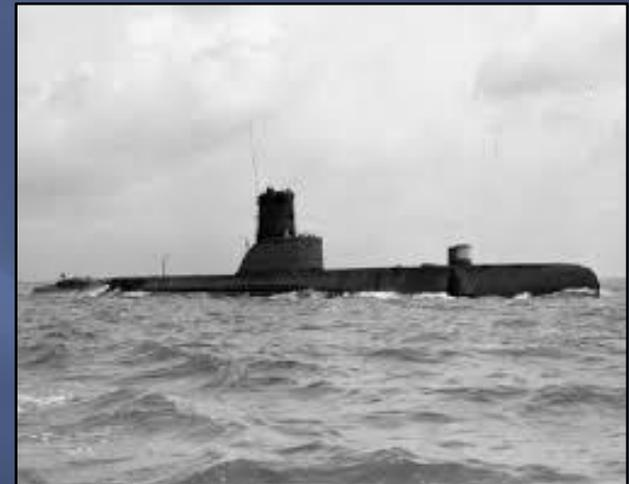
US-Balao-Klasse, Verdrängung: 1800/2499 t, Länge: 93,57 m, Breite: 6,30 m, Tiefgang: 5,20 m, Geschwindigkeit: 20/10 kn, 4 Diesel- und 4 E-Motoren, Besatzung: 76, Bewaffnung: 10 Torpedorohre oder 40 Minen; Kiellegung: 28.06.1943, Stapellauf: 15.11.1943, Indienststellung: 12.02.1944, an Brasilien: 23.10.1963, Außerdienststellung: 27.03.1973; Bauwerft: Portsmouth Naval Shipyard, Kittery, Maine, USA. - R-Dienstbrief aus D.R.Salvador vom 10.11.1969 und maschinenschrift. Absender (Foto: wikipedia)
