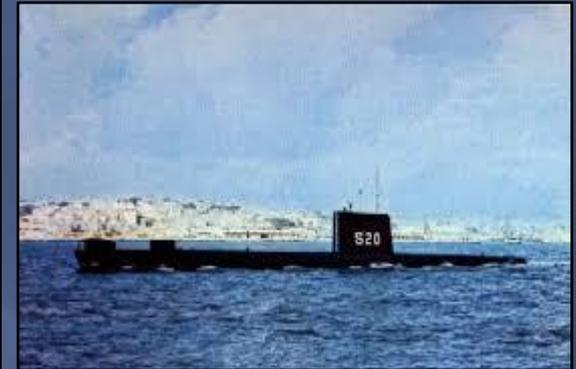
Britisch-Oberon-Klasse, Verdrängung: 1620/2040 t, Länge: 89,9 m, Breite: 8,07 m, Tiefgang: 5,48 m, Geschwindigkeit: 17,5/15 kn, 2 Diesel- und 2 E-Motoren, Besatzung: 74, Bewaffnung: 8 Torpedorohre; Kiellegung: 03.11.1970, Stapellauf: 05.10.1971, Indienststellung: 18.06.1973, Außerdienststellung: 08.04.1996; Bauwerft: Bauwerft: Vickers Limited, Barrow-in-Furness, UK. -Brief aus Marcilio Dias vom 31.10.1975 mit Dienststempel des Kommandanten (Foto: wikipedia)
