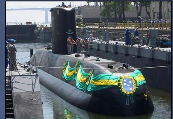
Typ deutsch 209/1400/Tikuna-Klasse, Verdrängung: 1250/1586 t, Länge: 62 m, Breite: 5,8 m, Tiefgang: 5 m, Geschwindigkeit: 11/22 kn, diesel-elektrischer Antrieb, Besatzung: 38, Bewaffnung: 8 Torpedorohre; Kiellegung: 11.06.1996, Stapellauf: 09.03.2005, Indienststellung: 01.07.2006; Bauwerft: Arsenal de Marinha do Rio de Janeiro, Brasilien (Foto: Indienststellung des U-Bootes). –Brief aus Rio de Janeiro vom 19.10.2009 mit Dienststempel des Kommandanten (Foto: wikipedia)
