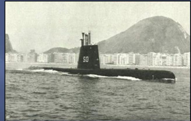
US-Tench-Guppy II-Klasse, Verdrängung: 1870/2420 t, Länge: 93,7 m, Breite: 8,3 m, Tiefgang: 5,5 m, Geschwindigkeit: 18/15 kn, 4 Diesel- und 4 E-Motoren, Besatzung: 83, Bewaffnung: 10 Torpedorohre; Kiellegung: 04.12.1944, Stapellauf: 02.03.1945, Indienststellung: 11.06.1945, an Brasilien: 06.07.1972, Außerdienststellung: 16.11.1978; Bauwerft: Portsmouth Naval Shipyard, Kittery, Maine, USA . – Brief aus Rio de Janeiro vom 21.07.1976 mit Bordstempel des U-Bootes (Foto: wikipedia)
