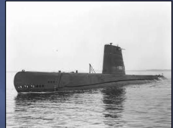
US-Balao-Guppy II-Klasse, Verdrängung: 1870/2420 t, Länge: 93,7 m, Breite: 8,3 m, Tiefgang: 5,5 m, Geschwindigkeit: 18/15 kn, 4 Diesel- und 4 E-Motoren, Besatzung: 76, Bewaffnung: 10 Torpedorohre; Kiellegung: 22.06.1944, Stapellauf: 27.10.1945, Indienststellung: 29.04.1946, an Brasilien: 28.07.1972, Außerdienststellung: 10.10.1983; Bauwerft: Electric Boat Company, Groton, Connecticut, USA. – Brief aus Marcilio Dias vom 11.03.1975 mit Dienststempel des U-Bootes (Foto: wikipedia)
